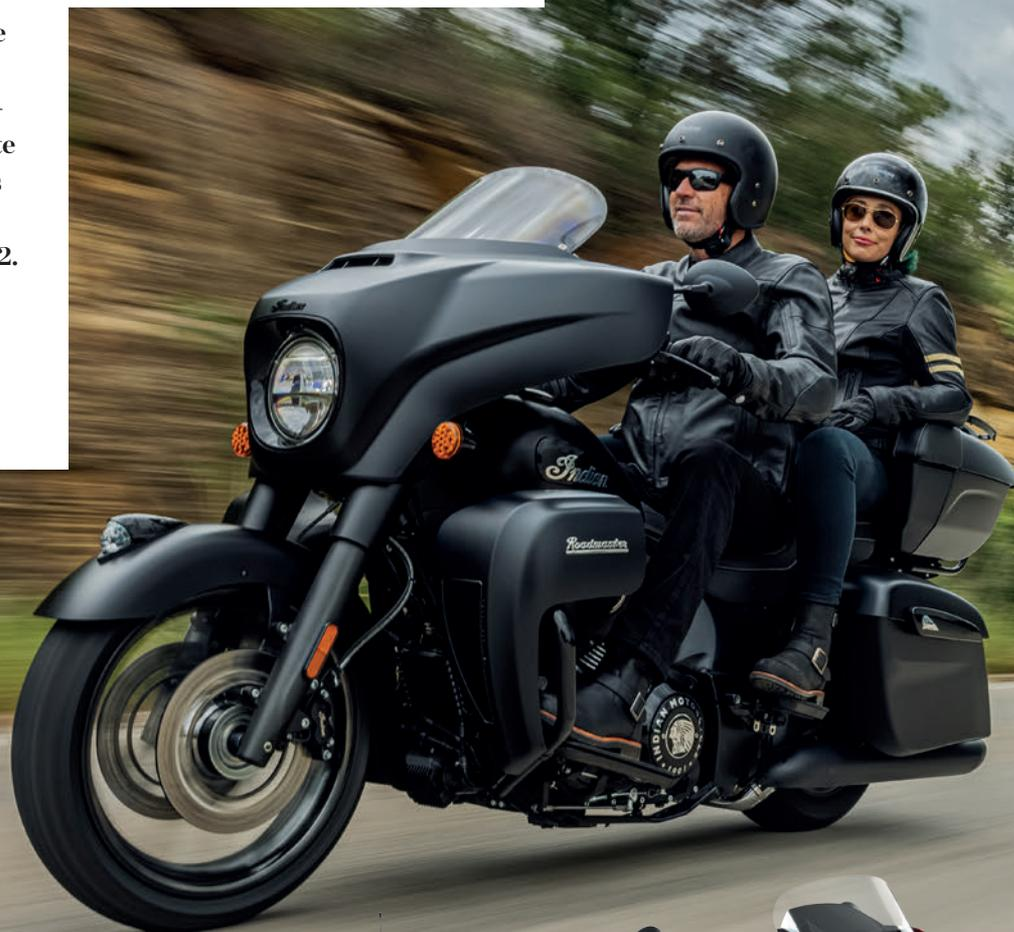
**Les gros cubes de la marque sont partagés entre la motorisation bicylindre Thunderstroke 116 de 1890cc à refroidissement par air et la motorisation PowerPlus de 1768cc et 122cv à refroidissement liquide que l'on retrouve sur le modèle Challenger.**
