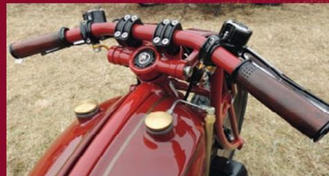
est extrêmement soigné pour rendre chaque flexible, câble, gaine, le plus invisible possible. La transmission s'effectue par chaîne, la selle suspendue très minimaliste est gainée en cuir piqué et la roue arrière est enveloppée d'un semi garde-boue avec plaque numéro intégrée. L'électronique de l'injection comme de l'allumage sont cachés dans le faux réservoir d'huile sous la selle.
